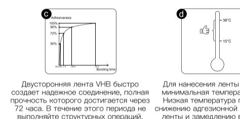
Двусторонняя лента VHB быстро создает надежное соединение, полная прочность которого достигается через 72 часа. В течение этого периода не выполняйте структурных операций.
