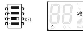
**В режиме ОХЛАЖДЕНИЯ (3-ий DIP переключатель в положении COOL) в НОЧНОМ режиме температура будет ПОВЫШАТЬСЯ на 4°.**
