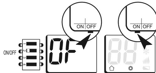
Если перевести DIP-переключатель в положение / , то переключатель на ПАНЕЛИ будет включать НОЧНОЙ и ДНЕВНОЙ режимы. В НОЧНОМ режиме установленная температура будет ПОНИЖАТЬСЯ на 4° относительно выбранного УСТАНОВОЧНЫМ ДИСКОМ значения. На дисплее будут отображаться символы или соответственно.
