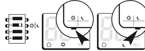
3 Переключатель №3. В положении HEAT включается управление системой отопления. На дисплее, при ВКЛЮЧЕНИИ системы отопления, будет отображаться символ .
