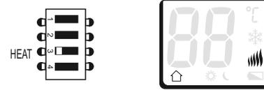
Если термостат управляет системой охлаждения, то переключатель устанавливается в положение COOL, на дисплее отобразится символ .
