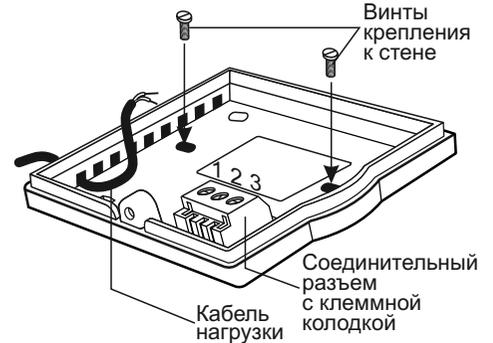
5. Подсоедините провода нагрузки к клемной колодке на соединительном разъеме в соответствии с типом включения нагрузки (нормально открытый контакт к контакту 1 (ON), а нормально закрытый контакт к контакту 2 (OFF) ), согласно схеме на рис.
