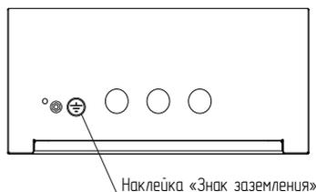
Место установки элемента заземления
