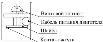
Рисунок 6 – Установка выхода на двигатель.
