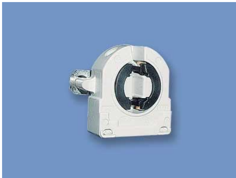
Патрон (ламподержатель) G13 торцевой, встраиваемый в 9,2мм для люминесцентной лампы T8,T12 с пружиной (крепление на цапфы)
