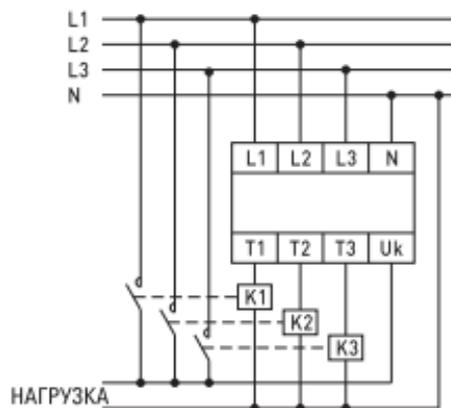
Рис. 5 Схема подключения (ток нагрузки более 16А)
