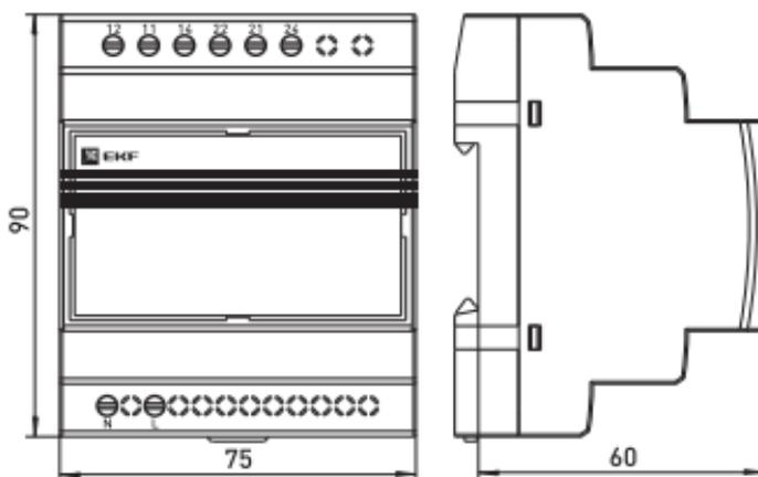
Рис. 6 Габаритные и установочные размеры
