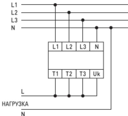
Рис. 4 Схема подключения (ток нагрузки менее 16А)
