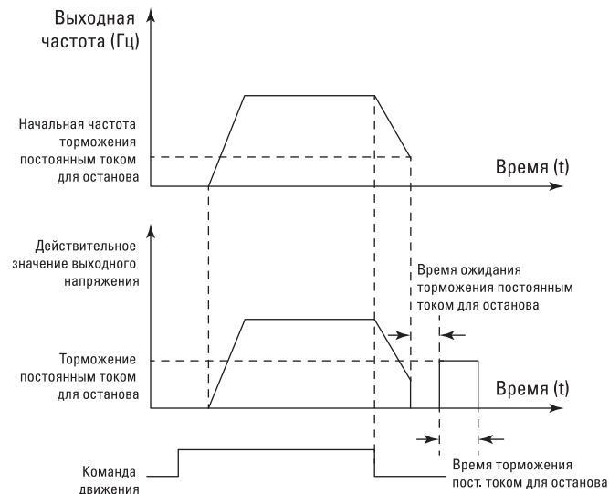
Рис. 6-13. Схема торможения постоянным током для останова
